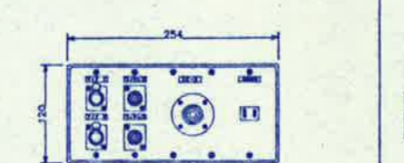
アンプ接続パネル
